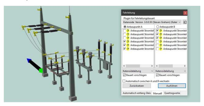
Typischer Aufbau eines Schaltfeldes mit Eingangsportal, Trenner/Erder, Wandler und Leistungsschalter. An die Leistungsschalter schließt das Sammelschienenfeld an. Die Leitungen werden mit der Katenoide Version von Steven Graham erstellt wie angezeigt. Die oberen 3 sind die vorderen Ankerpunkte und die unteren 3 sind die hinteren Anker jeweils von rechts nach links. Die Isolatoren müssen alle drei von rechts nach links angeklickt werden. Nur der jeweils untere Ankerpunkt wird aktiviert!
