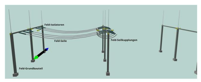
Beispiel für den Aufbau eines einfachen Feldes bestehend aus 3 Grundbauteilen für 2 Schienen mit Isolatoren, Seilen und einer Seilkupplung in der Mitte. An den Seiten befinden sich noch Anbaupunkte für Erweiterungen.
