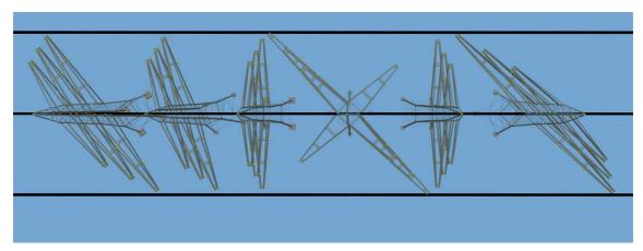
Kurze Ausleger haben im Beispiel die Masten 3 und 5 im Bild. Die Länge der Ausleger wird größer wenn die Leitungen die Richtung ändern, bei einer Richtungsänderung um 90° ist die Länge der Ausleger am größten und der Mast ist um 45° gegenüber den Trassen gedreht.
