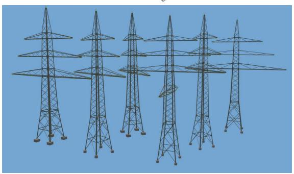
Auf einer geraden Trasse können für alle Masten die gleichen Oberteile verwendetet werden, Höhenanpassungen am Gelände erfolgen wesentlich durch den Stiel, für die Standsicherheit sorgt der Fuß mit entsprechender Standfläche.
