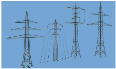
Weitere Beispiele von Masten, die beiden Masten in der Mitte sind Fertigmasten: Einer ist ein Endmast in einem Umspannwerk und ersetzt bei beengten Verhältnissen das Eingangsportal. Daneben ein Abzweigmast mit 2 durchgehenden Leitungen an den kurzen Traversen, an den Quertraversen zweigen 2 Leitungen ab.
