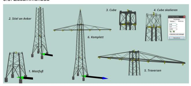
Das obige Beispiel zeigt den grundsätzlichen Zusammenbau eines einfachen Freileitungsmast:
