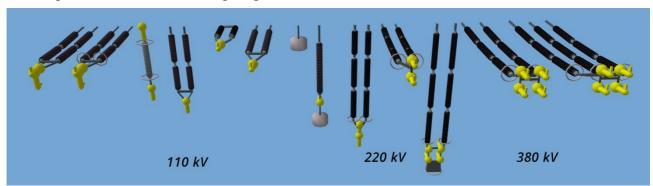
Die unterschiedlichen Isolatoren für Freileitungen im Baukasten. Die 3-fache Isolatorkette rechts ist für besonders hohe Zugkräfte ausgelegt.
