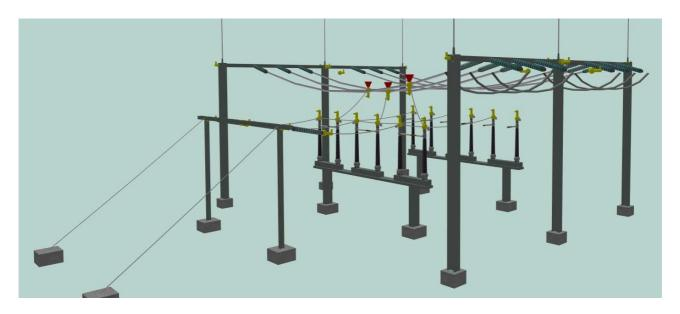
Unter dem Feld sind 2 Trennerbaugruppen aufgestellt, davor ein Abspannpunkt, die Baugruppen wurden quer zu den Stromschienen verbunden. Die ersten Trenner sind mit Hilfe von provisorischen Stromankern (rot) mit der Schiene verbunden. Die hinteren Trenner sind geöffnet.
