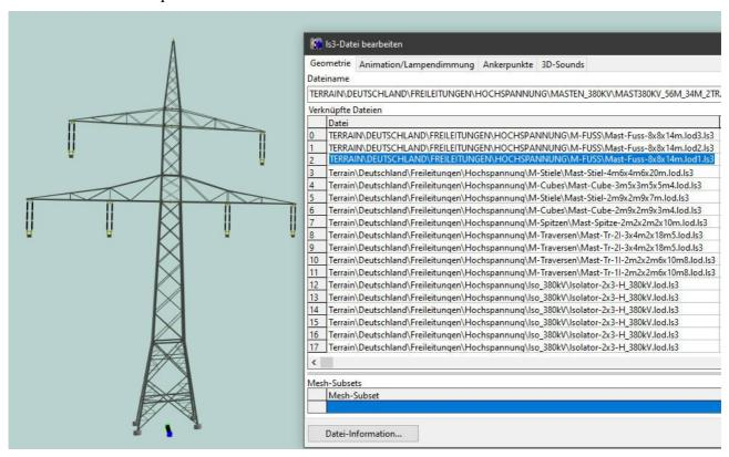
Das ist der vorgefertigte Tragmast "Mast380kV\_56m\_34m\_2Tr.lod.ls3" mit einer Höhe von 56m und einer maximalen Breite von 34m mit 2 Traversen. Dieser Mast trägt 2 Leitungen mit 3 Phasen.
